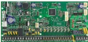
Alarmna centrala 16 zona, 2 particije, 2 PGM izlaza, komunikator, ispunava EN 50131 Security Grade 2 standard 8 ulaza za zone (16 sa dupliranjem) + max.15 zona na tastaturama, max. 24 dodatne zone (ukupno max.32 zone), max. 16 PGM-ova, mogućnost priključenja bežičnih senzora preko RTX3/RX1, StayD funkcija, 4-žična magistrala (bus), bez šifratora i kutije
