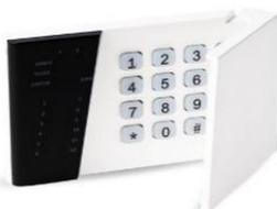
Žični šifратор Mehanička tastatura sa pozadinskim osvetljenjem Ugrađena zvučna signalizacija Max dužina kabla 100m Dodatna žičana zona Napajanje 12-14V DC150mA Radna temperatura -30....+55°C
