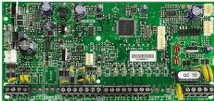
Alarmna centrala 10 zona, 2 particije, 2 PGM izlaza, komunikator, ispunava EN 50131 Security Grade 2 standard 5 ulaza za zone (10 sa dupliranjem) + max.15 zona na tastaturama, max. 24 dodatne zone (ukupno max.32 zone), max. 16 PGM-ova, mogućnost priključenja bežičnih senzora preko RTX3/RX1, StayD funkcija, 4-žična magistrala (bus), bez šifratora i kutije
