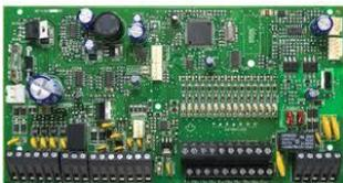
Alarmna centrala 32 zone, 2 particije, 4 PGM izlaza, komunikator 16 ulaza za zone (32 sa dupliranjem) + max.15 zona na tastaturama, max. 16 dodatnih zona (ukupno max.32 zone), max. 16 PGM-ova, mogućnost priključenja bežičnih senzora preko RTX3/RX1, StayD funkcija, 4-žična magistrala (bus), bez šifratora i kutije
