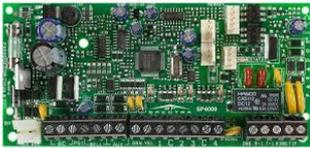
Alarmna centrala 8 zona, 2 particije, 1 PGM izlaz, komunikator, ispunjava EN 50131 Security Grade 2 standard 4 ulaza za zone (8 sa dupliranjem), StayD funkcija, 4-žična magistrala (bus), bez šifratora i kutije, mogućnost priključenja bežičnih senzora preko RTX3/RX1 modula.
